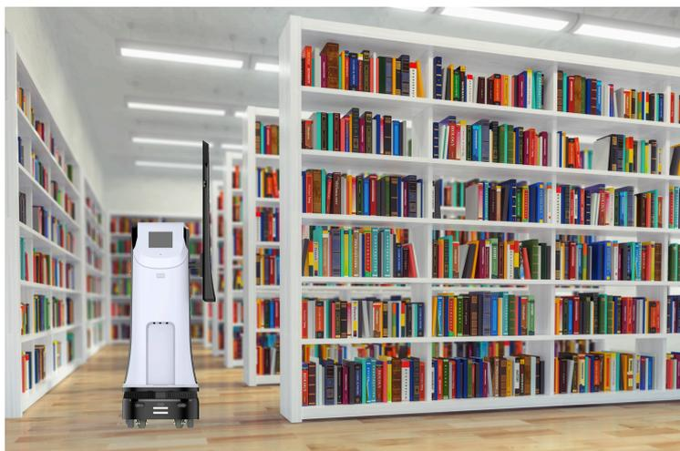
书架区域机器人按照设置好的时间周期和覆盖范围，自动进行轮询拍摄，上传盘点图像数据到中心服务器进行分析处理，设置完成后无需人工干预，如有设备状态异常，系统会预警提示技术人员进行查看维护。
